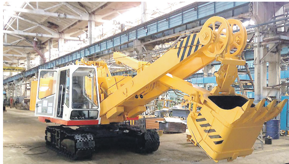
Экскаватор ЭО-4112 в сборочном цехе завода.
